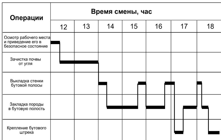
Рисунок 24.5 — Линейный график выполнения работ при выкладке бутовой полосы
