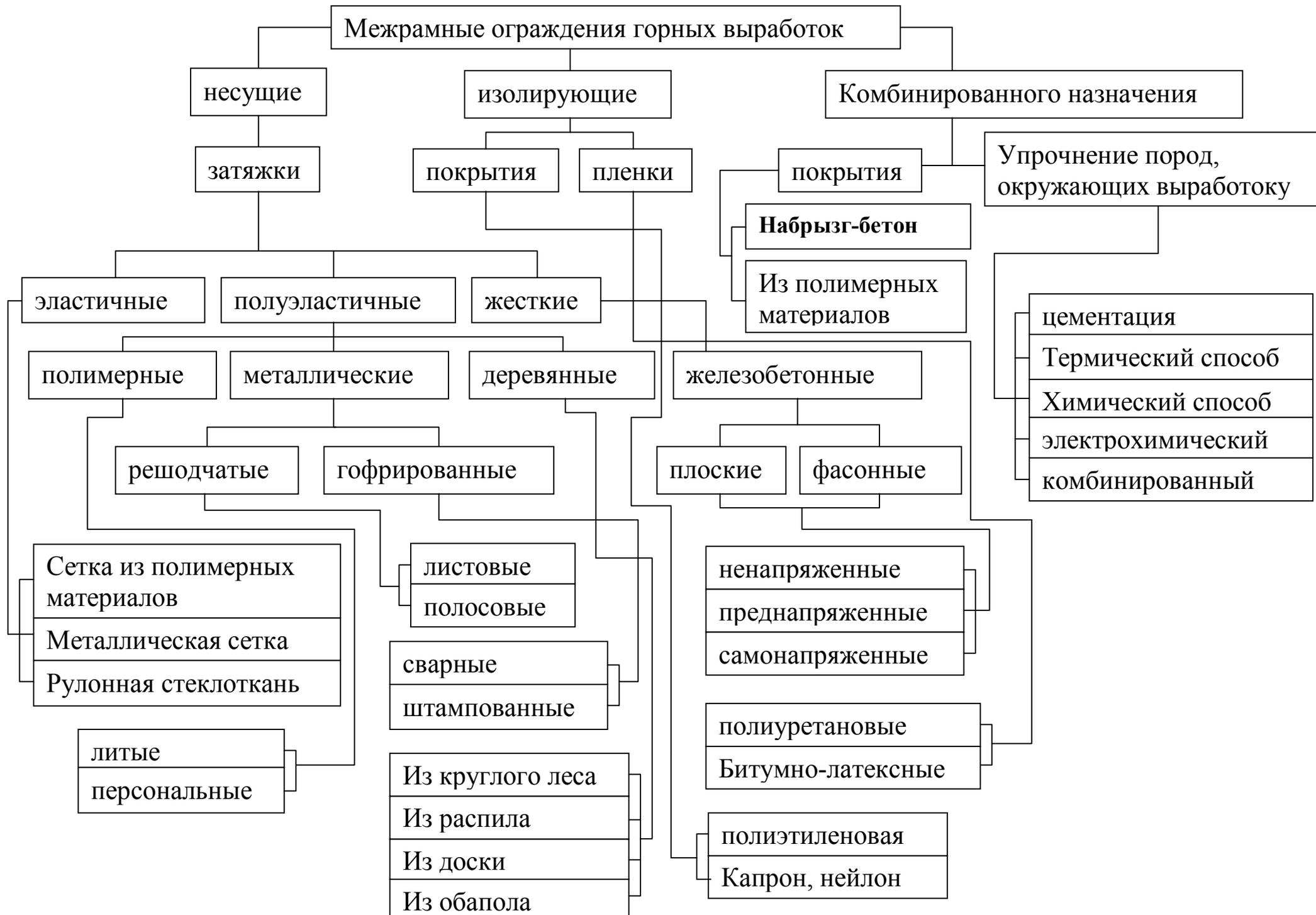
её изготовления, транспортирования и укладки, а также относительно низкой стоимостью. В то же время недостаточная несущая способность (разрушение наступает при нагрузке 10-20кПа ( 4.6 ) ) и малый срок службы (0,5-3 года) вследствие гниения становятся причинами массового отказа деревянных затяжек в виде внезапного хрупкого излома с запредельными деформациями (рис. 4.2).
