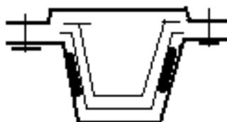
Шарнирная замкнутая конструкция состоит из 4-х частей. Ширина такой крепи в черне 4.8м, для замкнутой конструкции высота такая же. В свету высота на 84см меньше. Радиус кривизны 2.97м.
