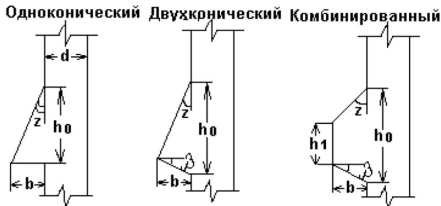
Опорный венец является элементом крепи, который за счет заглубления в породу создает опору для выше- и нижерасположенных звеньев крепи. Расстояние между опорными венцами – звено крепи (принимается в зависимости от крепости пересекаемых пород) от 20 до 60м. При железобетонной крепи применяют три вида венцов:
