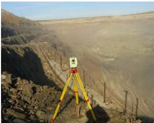
Рисунок 24 — Инструментальный контроль западного борта Соколовского карьера
