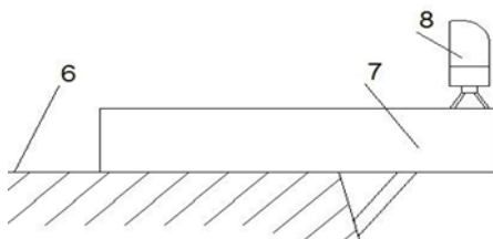
Рисунок 37 — Стационарный пункт дистанционного контроля: 1 — металлический репер; 2 — механизм пружинного крепления телескопического става фиксатора с репером; 3 — телескопический став для обеспечения плотного соприкосновения фиксатора с верхней бровкой откоса уступа; 4 — саморегулирующийся прижимной пружинный фиксатор; 5 — сферический отражатель жестко связанный с фиксатором; 6 — локальный участок бермы; 7 — стационарный пункт дистанционного контроля; 8 — лазерный сканер
