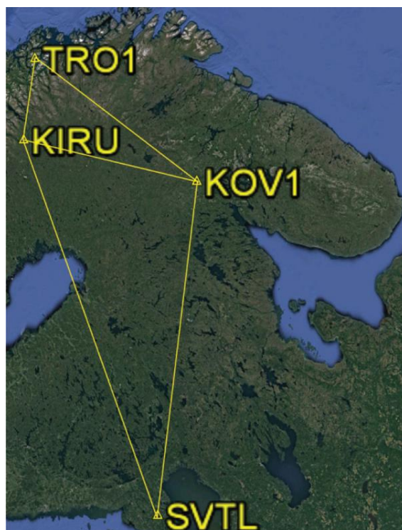
Рисунок 16 — Сеть пунктов для определения координат опорного пункта KOV1 (рудник «Железный» АО «Ковдорский ГОК»)
