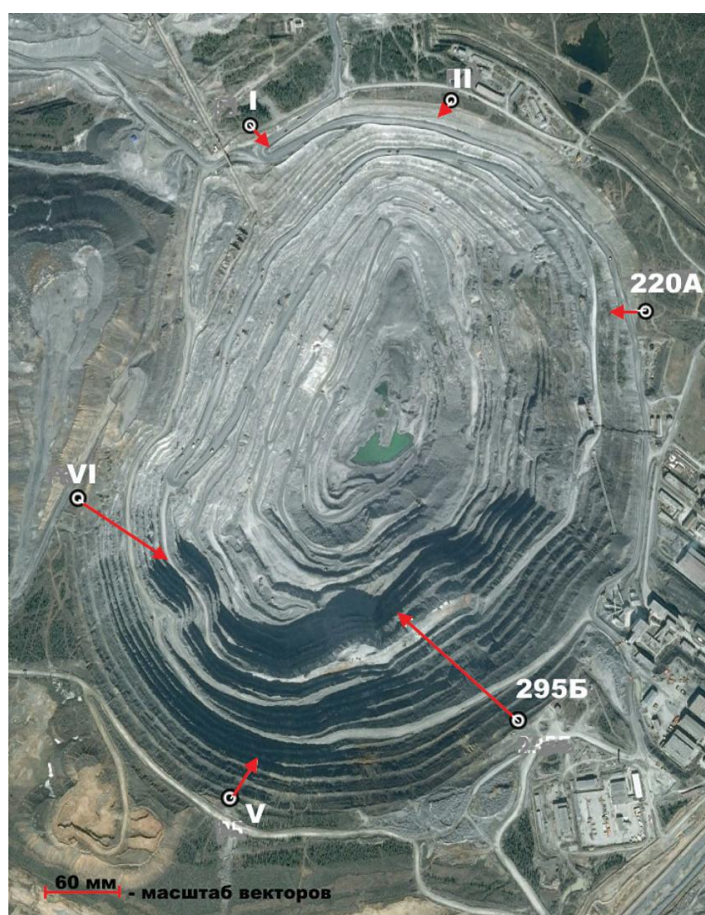
Рисунок 17 — Схема смещений (в плане) фундаментальных пунктов внутреннего контура в период 26.09.2011 г. — 02.11.2016 г.
